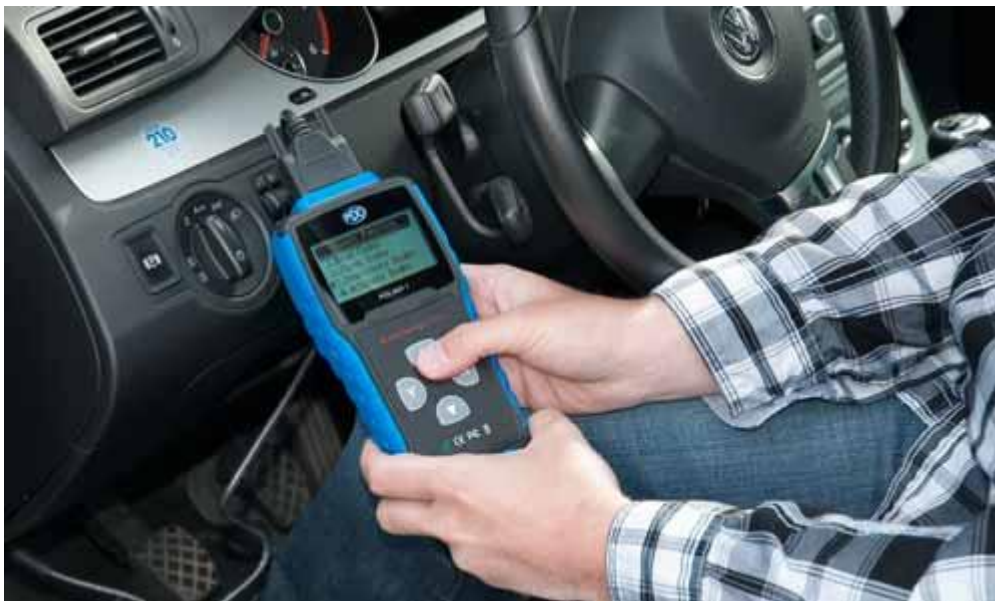
De elektronische remtester PCE-BST 1 bij het deactiveren van een parkeerrem.
