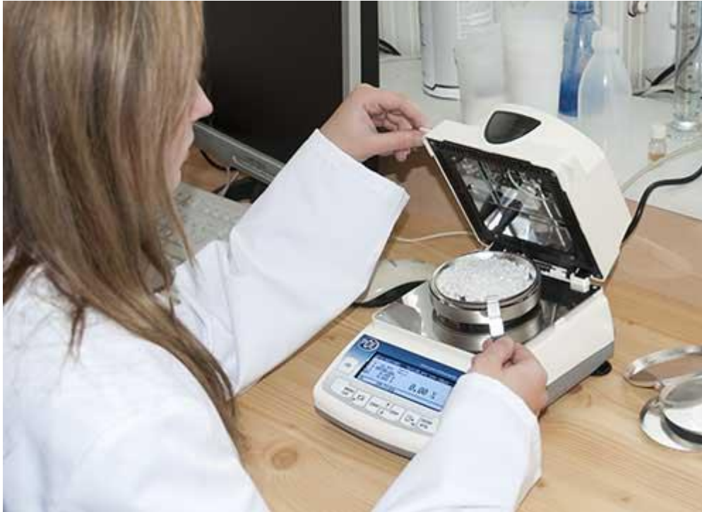
Droging van granulaat met de Mini vochtbepaler serie PCE-MB C
