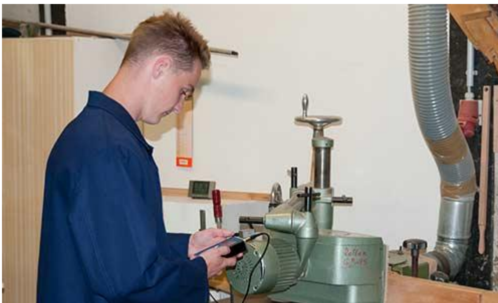
De Trillingsmeter PCE-VM 3D tijdens een meting bij een motor
